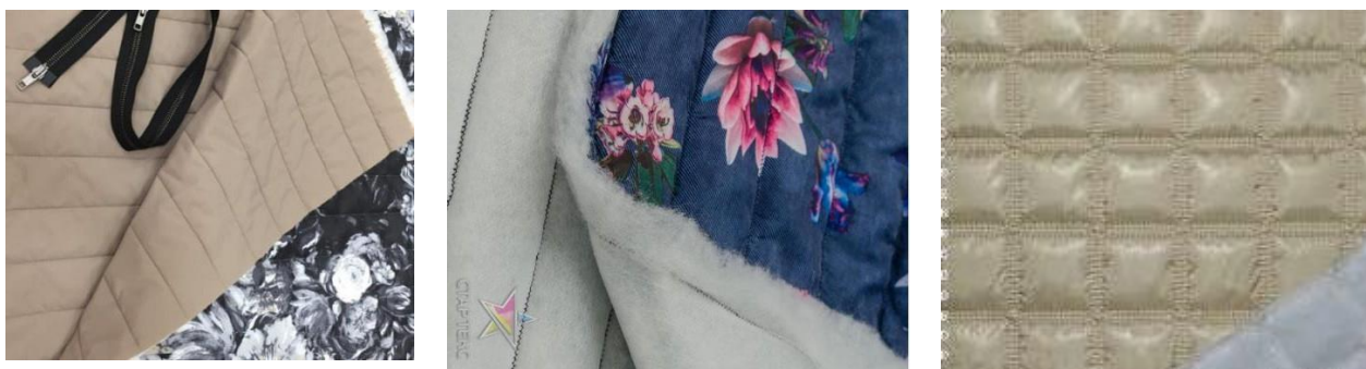
Рис. 2 – Приклади стьобаних матеріалів: а) двосторонній матеріал ниткового з'єднання; б) односторонній матеріал ниткового з'єднання; в) односторонній матеріал зварного з'єднання
