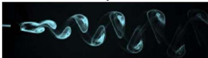
Рис. 2. Схема, що ілюструє утворення вихорів Кармана [1]
