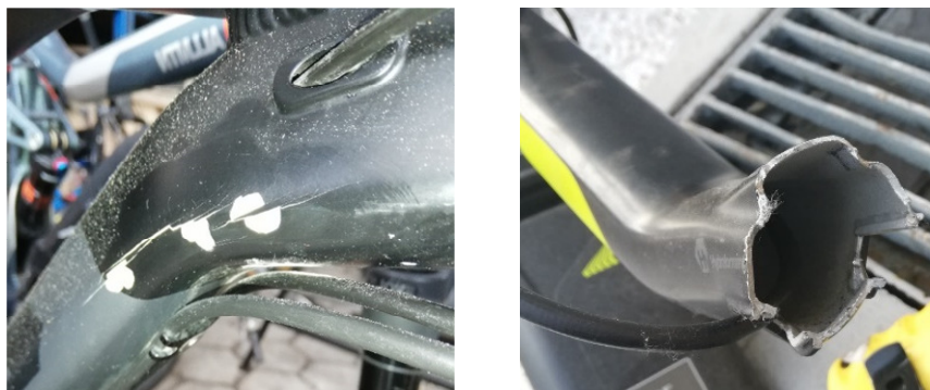
Rysunek 13. Przykłady pęknięć i złamań ram rowerów górskich
