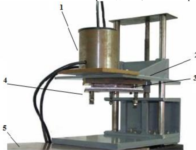
Рис.1. Загальний вигляд магнітно-імпульсної установки: 1 – розрядник, 2 – корпус установки, 3 – індуктор, 4 – супутник, 5 – блок живлення.
