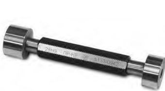
Рис. 3.6. Двобічна повна пробка
