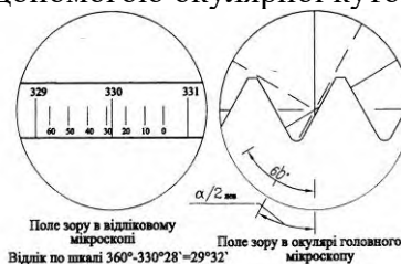
Рис.9.4. Поле зору в окулярі при вимірюванні \alpha/2_{\text{лев}}
