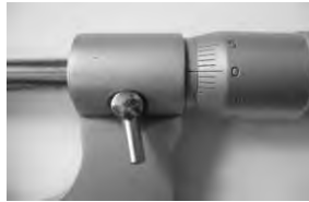
Рис. 5.3 – Встановлення мікрометра на нуль
