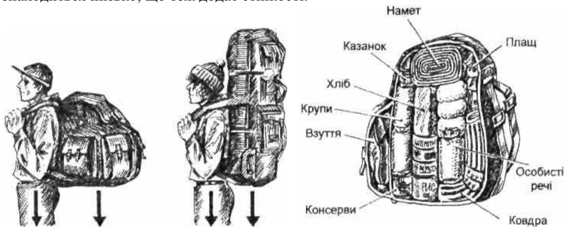
Рис. 3. Центр ваги туриста і рюкзаків різної конструкції та пакування
