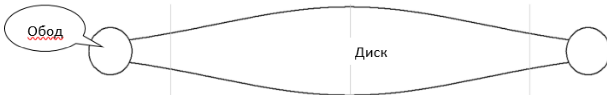
Рис. 2. Ресурсозберігаюча форма перерізу кінетичного акумулятора, маховика.
