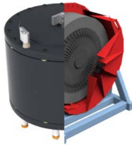
Рис.1. Супермаховик невеликої ємності, 20 кВт-год
